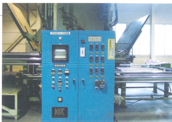
700トン2段プレス加硫成型機 熱盤1500×1500mm大型プレス
